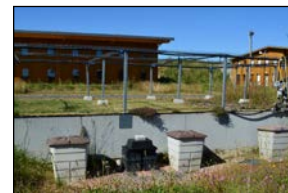
Mise en place d'un simulateur de pluie afin de mesurer les précipitations.
