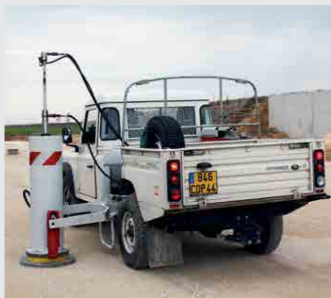
La portance peut être contrôlée à l'aide d'une dynamolaque normalisée qui simule une déflexion enregistrée sur un ordinateur.
